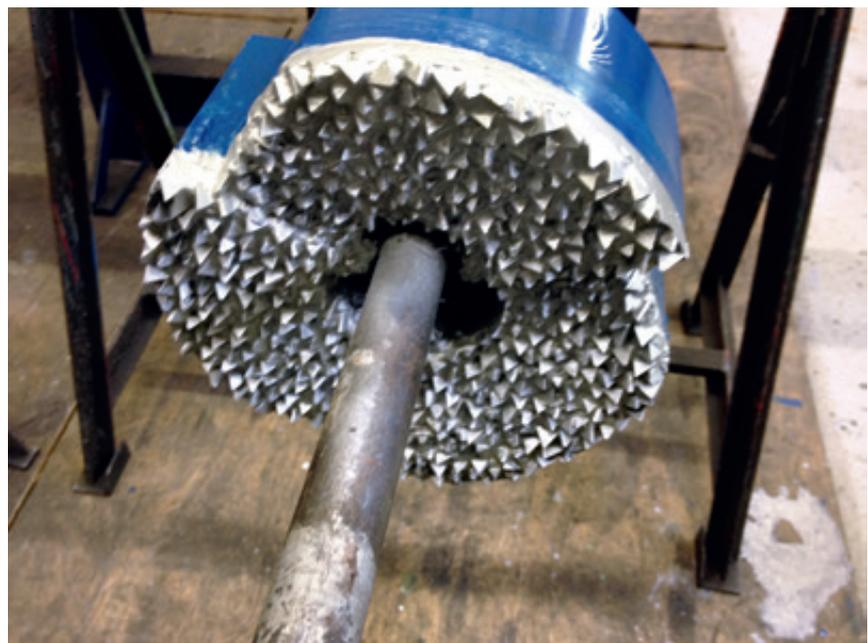
Abb. 9: Beispiel eines Fräskopfes, wie er beim Zerbohren nichtmetallischer Ausbaumaterialien zum Einsatz kommen kann.
