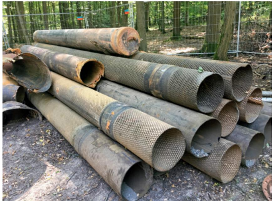
Abb. 8: Rückgebaute alte Brunnenausbaurohre
