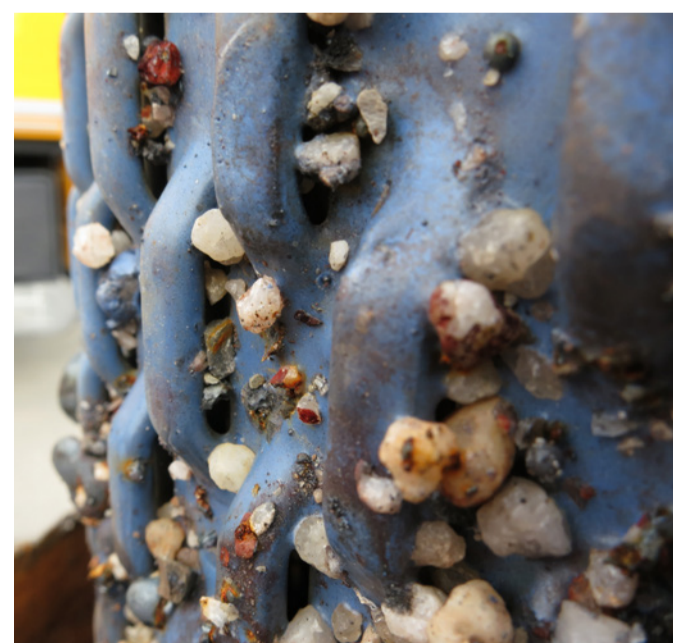
Bild 4: Rückbau aufgrund irreversibel verstopfter Schlitze durch Unterkorn der Kiesschüttung
